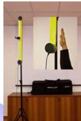
Слика 6. Вертикално поставена оптичка подлога за мерење на дофатната висина
